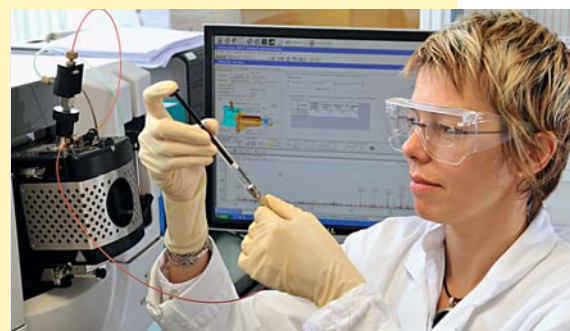
Estelle Gueneau, directora del laboratorio de Annemasse, inyecta una muestra de material en el cromatógrafo de gases GCIMS.
