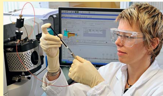
Estelle Gueneau, responsable du Laboratoire d'Analyse d'Annemasse, injecte un échantillon de substance dans un chromatographe en phase gazeuse GC/MS.
