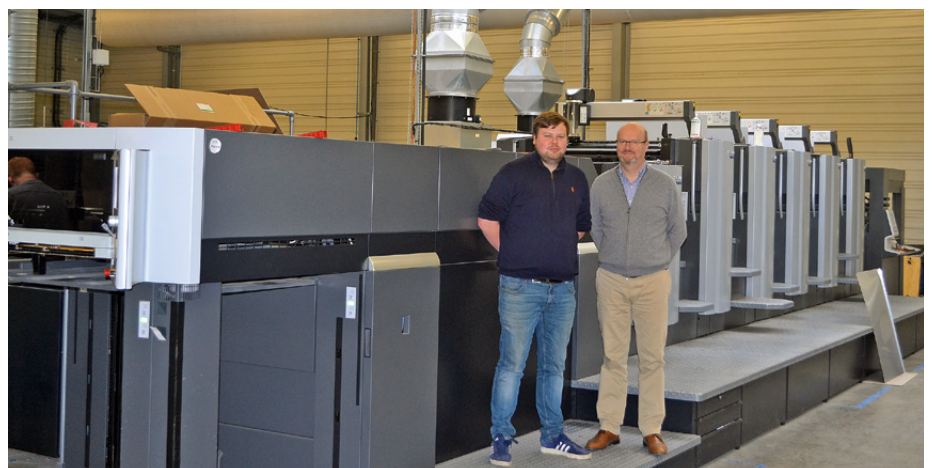
M. Christophe Capelle (droite) devant la nouvelle presse offset 5 couleurs UV LE-UV Heidelberg CX 102.
