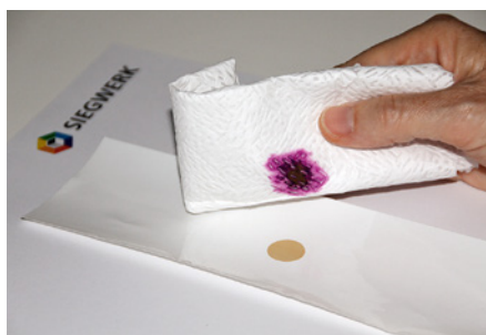
Più chiara è la macchia, migliore è l'indurimento del bianco coprente/vernice.
