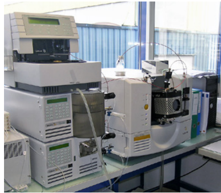
Uno de los diversos espectrómetros LC-MS para análisis de migración.
