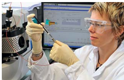
La directora del Laboratorio Analítico de Annemasse, Estelle Gueneau, inyecta una muestra de material en un cromatógrafo de gases GC/MS.
