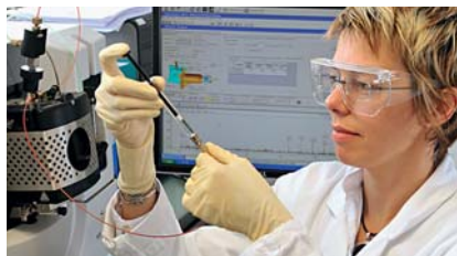
Estelle Gueneau, responsável do Laboratório Analítico de Annemasse, injeta uma amostra de material em um cromatógrafo a gás GC/MS.
