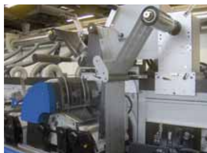
Groupe offset avec unité de contre-collage Cold Foil
